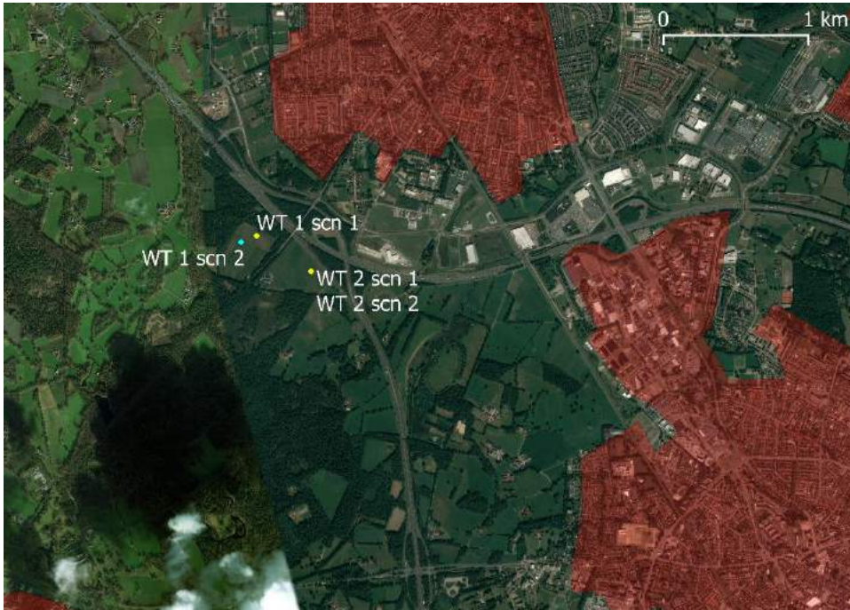
Figuur 1 De gele stippen geven de locaties aan van de nieuwe windturbines voor scenario 1. De cyaan stippen de locaties van de nieuwe windturbines voor scenario 2. WT 2 valt voor beide scenario's samen op 1 locatie. [Bing]
